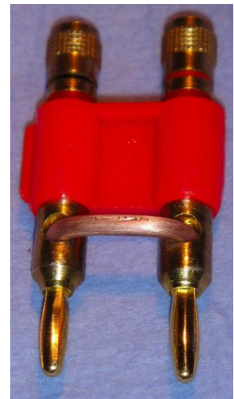
Fig. N2 – 0.0186 \Omega shunt.
